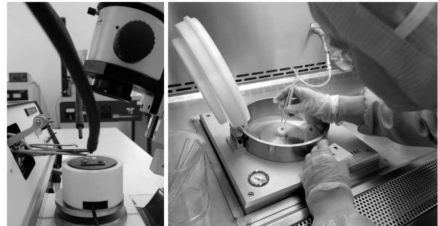
Im neuen Reinraum: Ein Wissenschaftler bringt elektronenstrahlempfindlichen Lack auf die Proben auf (rechts). Links ein Gerät für die elektrische Kontaktierung der Nanostrukturen.
