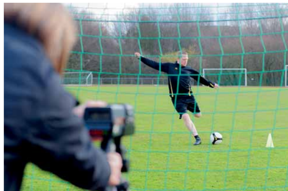
Schneller als blinzeln: Bei einem Schuss berühren sich Schuh und Ball nur bis zu zwölf Millisekunden lang. Den winzigen Moment hält die Kamera fest (l.). Beim Slalomlaufen überprüft das Biomechanik-Team, wie sich der Schuh am Fuß und auf dem Rasen verhält.
