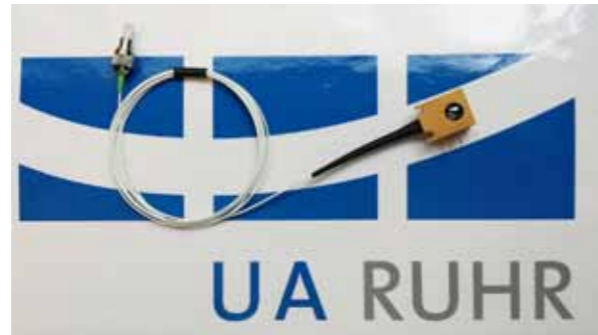
Dies ist der wesentliche Baustein des Sensors: ein photonisches Terahertz Sende- und Empfangsmodul.
