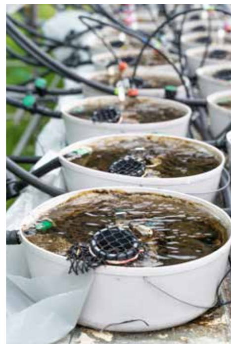
Der Einfluss multipler Stressfaktoren auf die Biodiversität soll auch mit Mesokosmen-Experimenten analysiert werden. Im Bild ist das ExStream-System an der Kinzig, Hessen.
