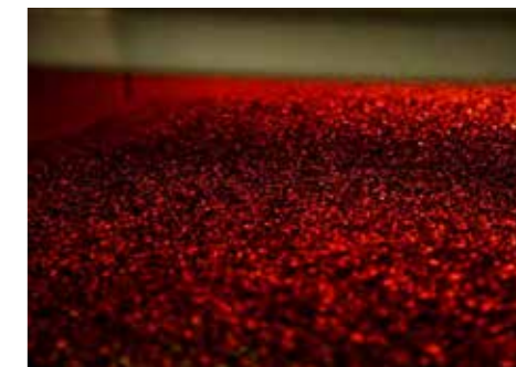
Hochlegierte Stahlspäne nach der Reinigung, bereit für die Wiederverwendung.
