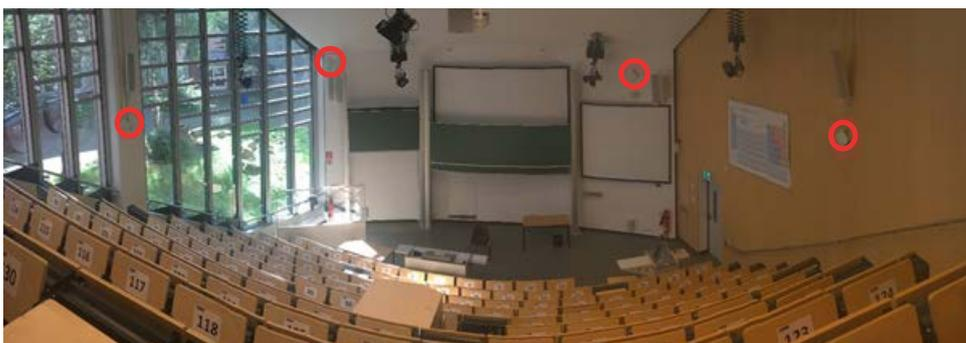
Abbildung 1: Hörsaal MC121 - Im roten Kreis sind Access Points modernisiert
