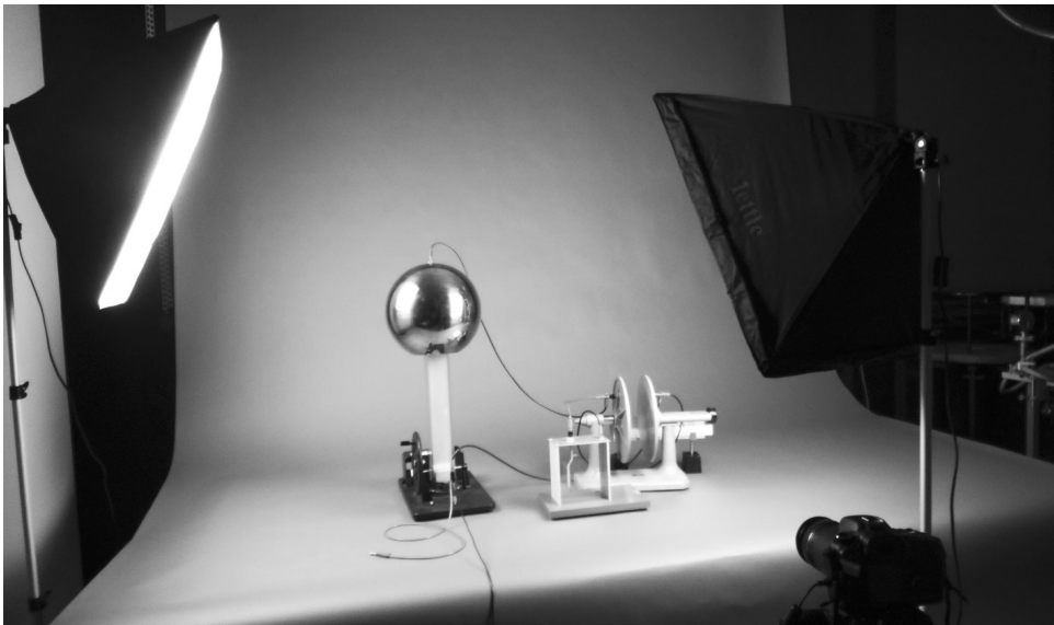
Abb. 2: „IBE-Labor“ mit Aufnahmebühne, Beleuchtung, Kamera und Aufbau für ein Interaktives Bildschirmexperiment.
