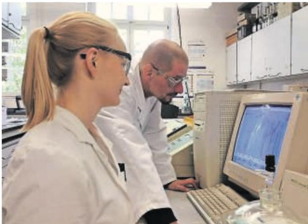
Ausbilder Jörg Totzke und Isabell Arentz (22) arbeiten mit einem Gerät, das die Absorption von Infrarotlicht misst. Damit kann beispielsweise die Schichtdicke einer Folie bestimmt werden.
