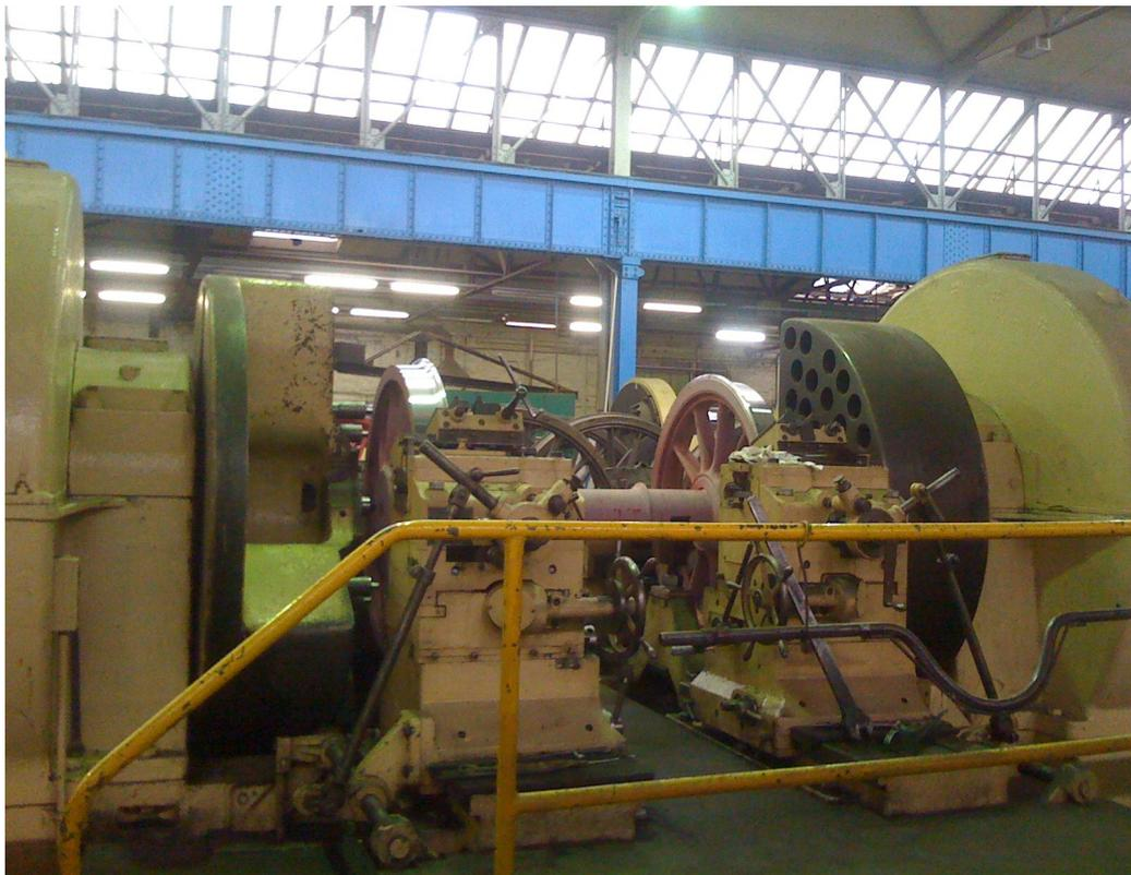
**Räder bis zu einem Durchmesser von 2,10m können auf dieser Maschine bearbeitet werden.**
