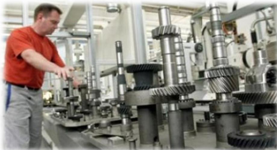
**Bild 3: Montage der Getriebe**
