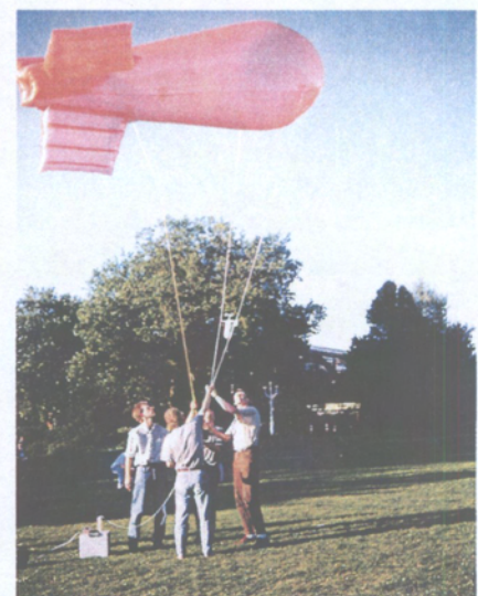
Abb. 3. Fesselballonsondierungsanlage zur Messung von Lufttemperatur, relativer Feuchte, Windgeschwindigkeit und Windrichtung.
