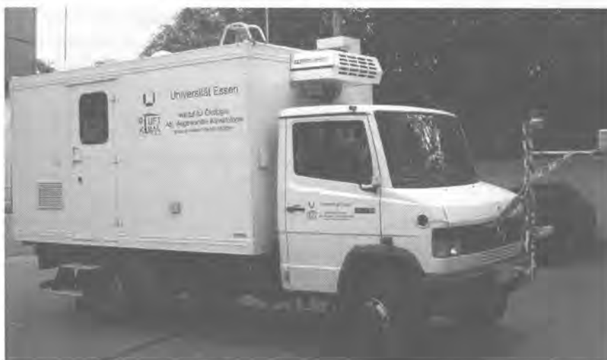
(4) Messfahrzeug der Abteilung Angewandte Klimatologie und Landschaftsökologie der Universität Essen zur Erfassung meteorologischer und lufthygienischer Komponenten.
