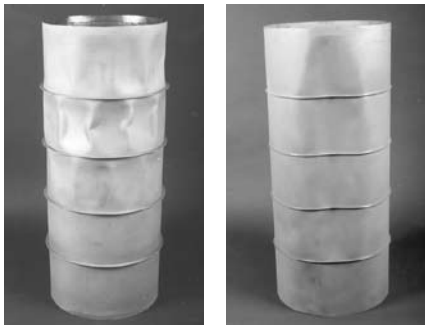
(14) Stählerne Schalenmodelle, die unter Manteldruck lokal (a) bzw. global (b) eingebeult sind.
