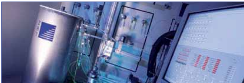
Tragbares Gaswerk: Mobiler Reformer (lks.) auf dem ZBT-Prüfstand.
