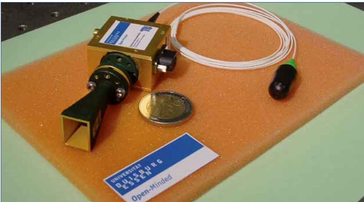
Innovation made in Duisburg-Essen: Funksender iPHOS mit der trichterförmigen Hornantenne und der Glasfaser
