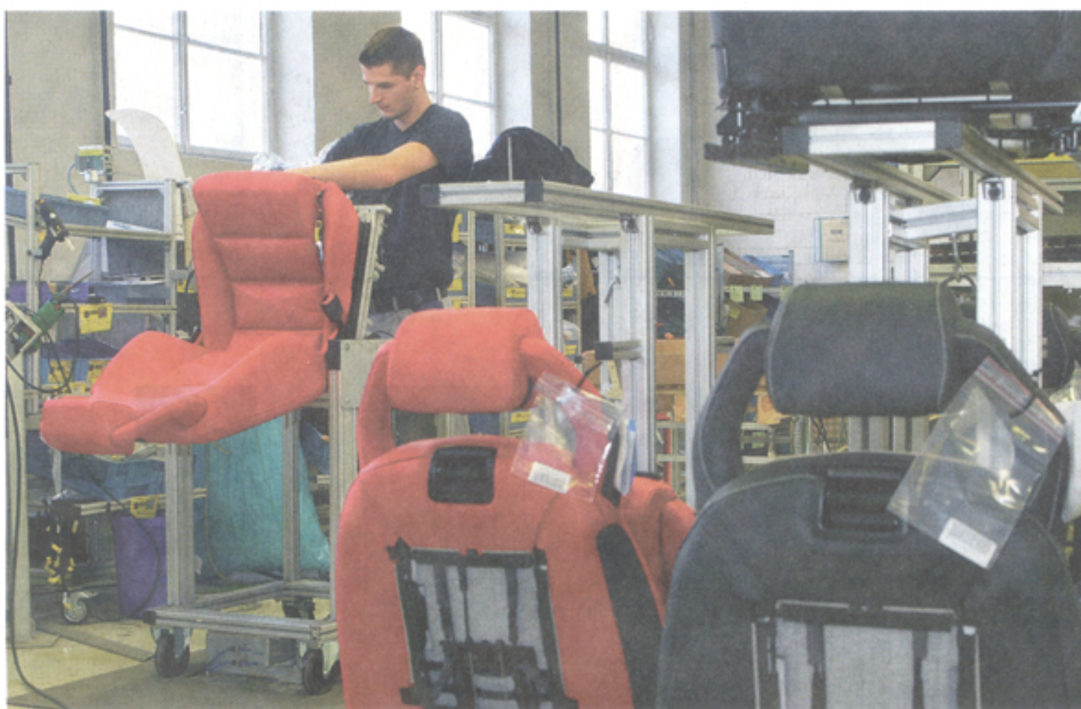
Der Sitz für den Lamborghini wird hier noch ganz herkömmlich bei Recaro zusammengeschraubt.
